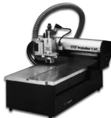
Рис. 1. Координатно-фрезерный станок ProtoMat C60
