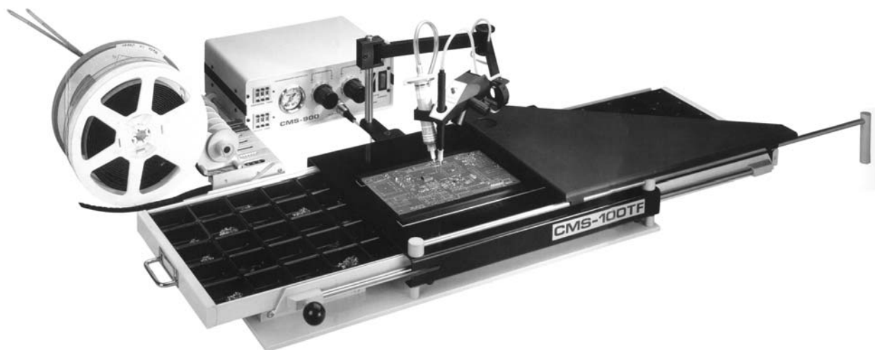
Рис. 4. Устройство CMS-100TF для ручной установки компонентов на плату
